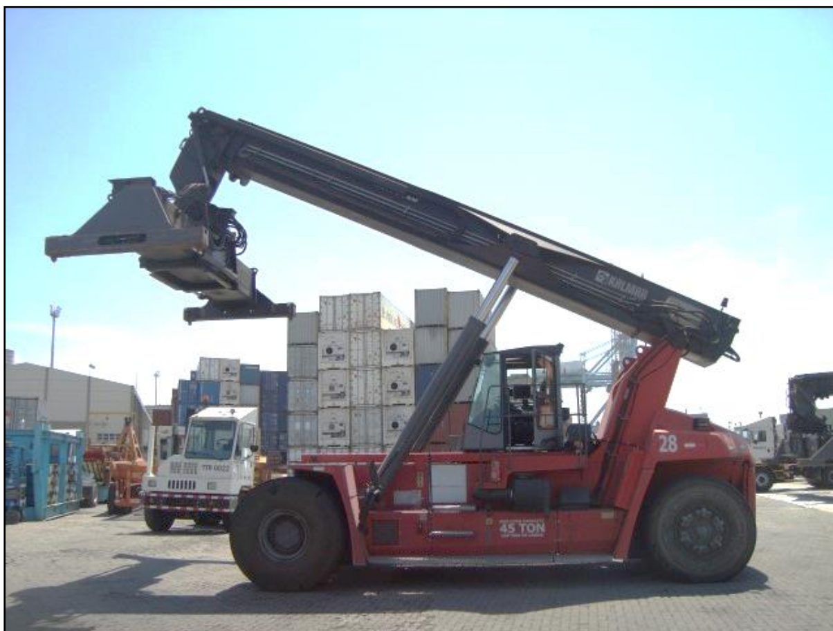
Figura 1. Empilhadeira de grande porte (Reach-Stacker), RSK-0028.
