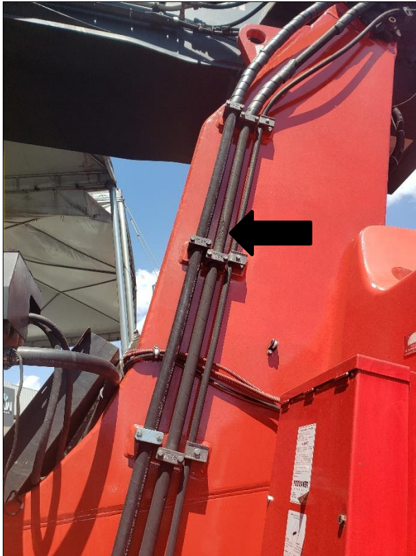
# item 44 – mangueira que sobe para lança lado esquerdo apresenta trama exposta
