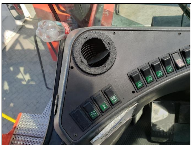
# item 5 – difusor de ar do painel quebrado
