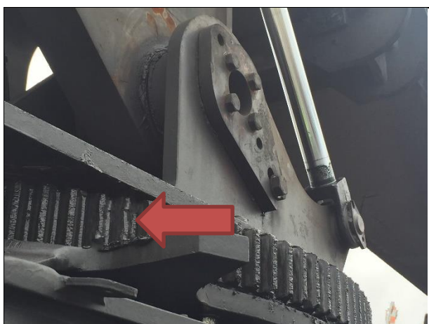
# item 30 – 2 dentes da coroa de giro quebrados (coroa virada)
