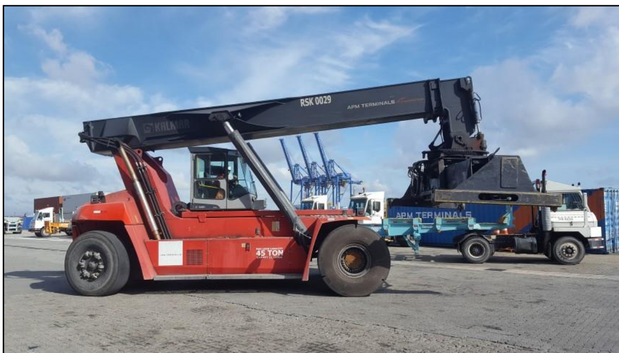
Figura 1. Empilhadeira de grande porte (Reach-Stacker), RSK-0029.
