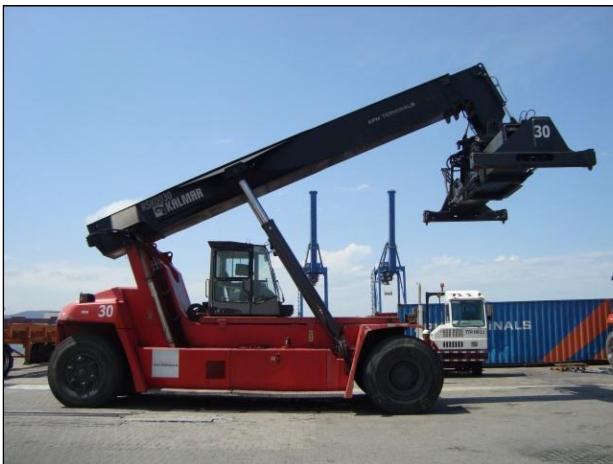
Figura 1. Empilhadeira de grande porte (Reach-Stacker), RSK-0030.
