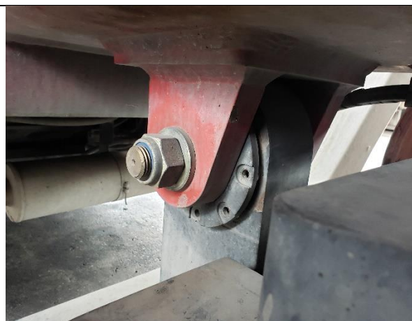
# item 42 – bucha da balança com desgaste
