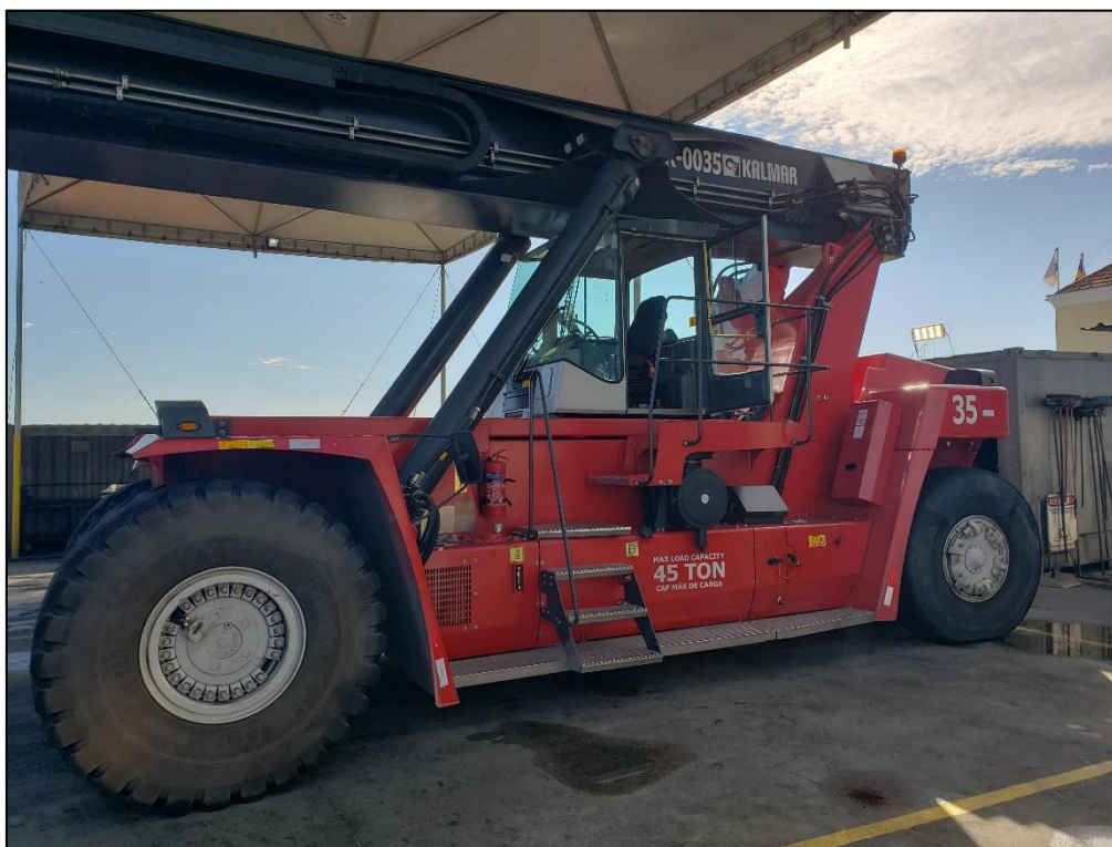
Figura 1. Empilhadeira de grande porte (Reach-Stacker), RSK-0035.
