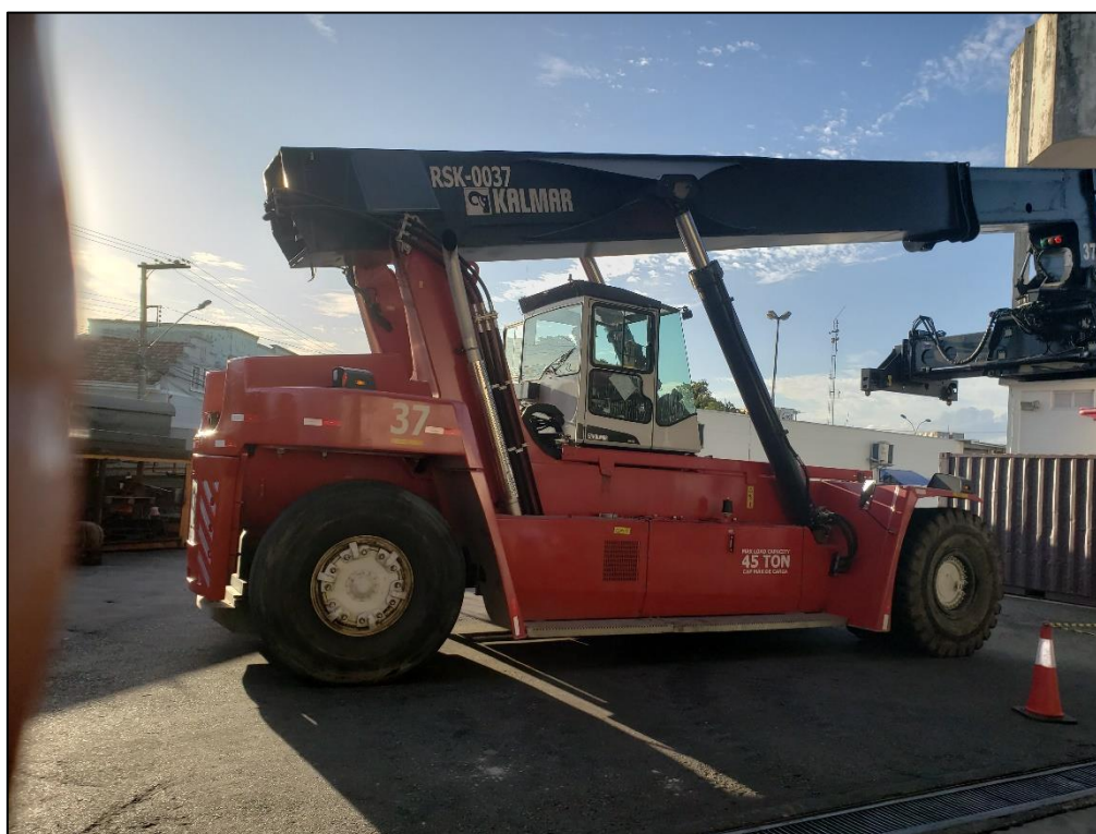
Figura 1. Empilhadeira de grande porte (Reach-Stacker), RSK-0037.
