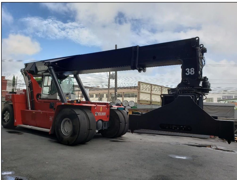
Figura 1. Empilhadeira de grande porte (Reach-Stacker), RSK-0038.
