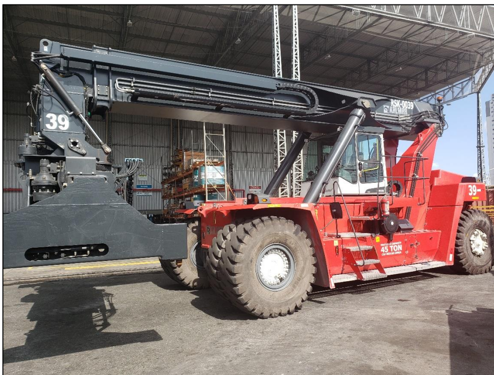
Figura 1. Empilhadeira de grande porte (Reach-Stacker), RSK-0039.
