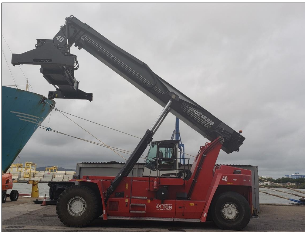
Figura 1. Empilhadeira de grande porte (Reach-Stacker), RSK-0040.
