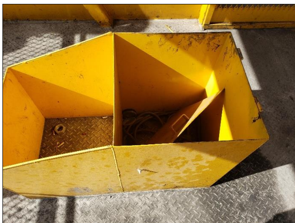
# item 2 – tampa da caixa guarda volumes quebrada
