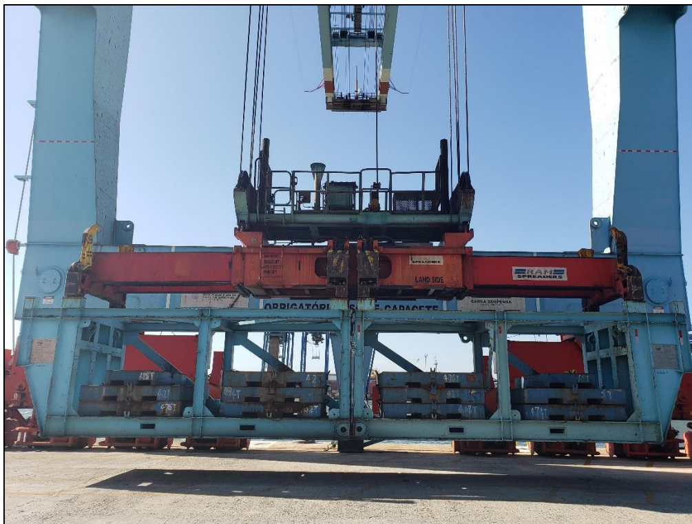
Figura 5. Teste de carga – Twin Lift.
