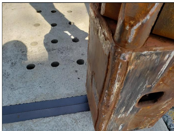
# item 2 – desgaste na chapa do canto da caixa do pino lock
