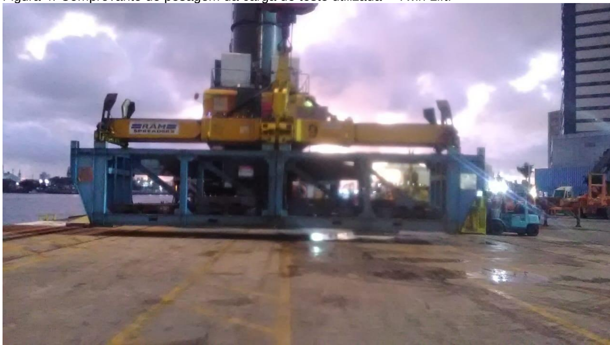
Figura 5. Teste de carga – Twin Lift.
