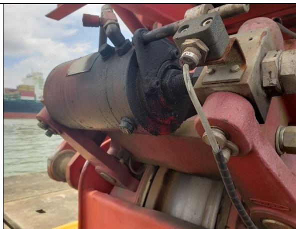
# item 2 – vazamento no cilindro atuador do freio da roda
